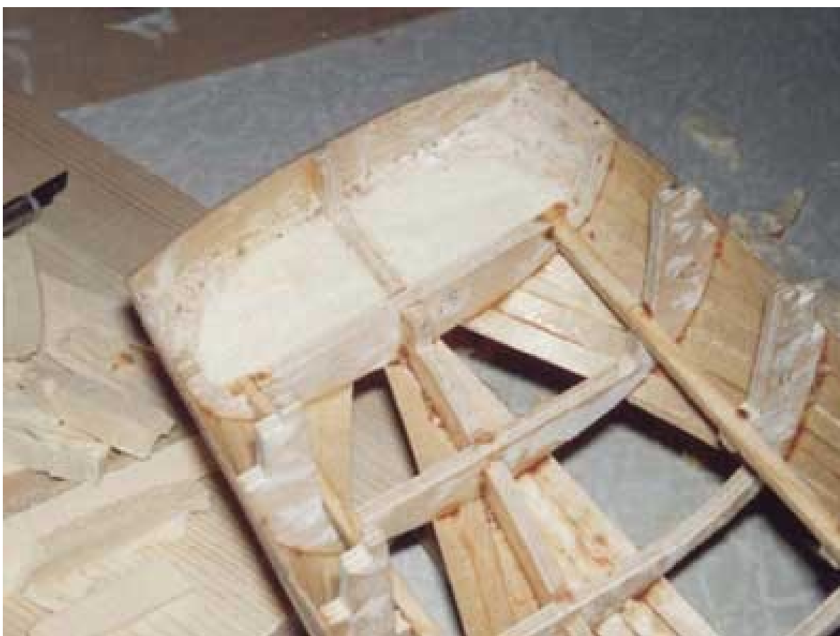
Так виглядає корма зсередини. Піна зрізана по рівень палуби юта.
